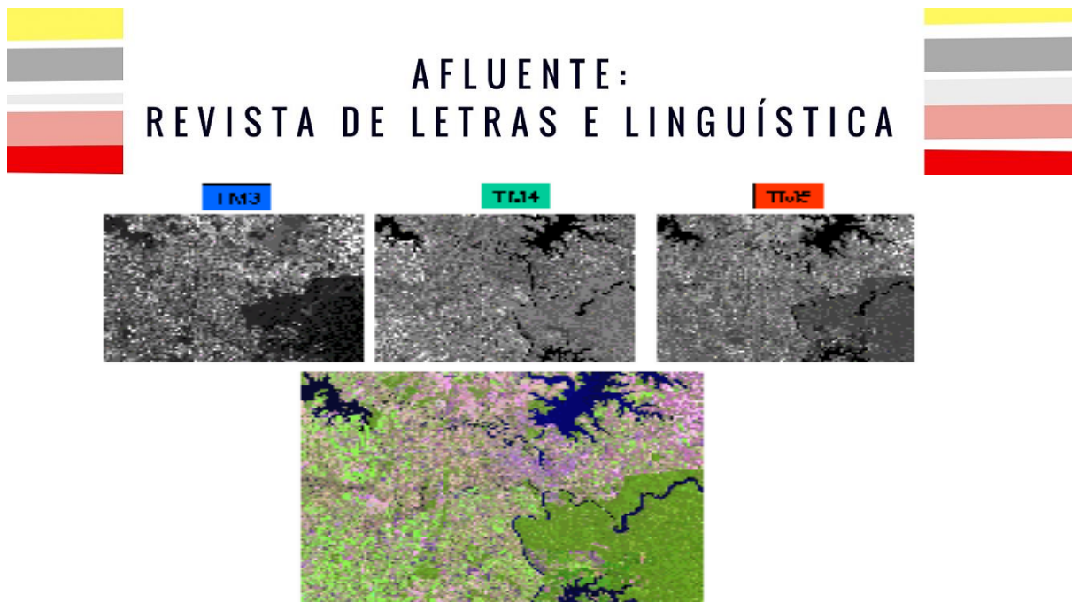
Figura 3 – Imagem em composição colorida utilizando as bandas TM-3 (vermelho), TM-4 (infravermelho próximo) e TM-5 (infravermelho médio) do sensor ETM+ do satélite Landsat-7 (órbita 224, ponto 78) de 05 de agosto de 1999.
